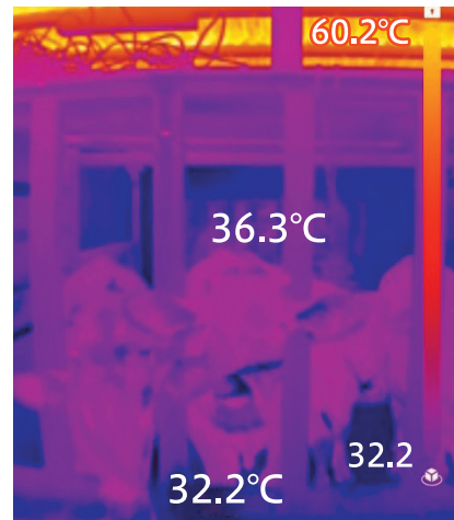
牛舎内温度の分布(子牛房) (資料提供:非常勤コンサルタント 知念雅昭)
